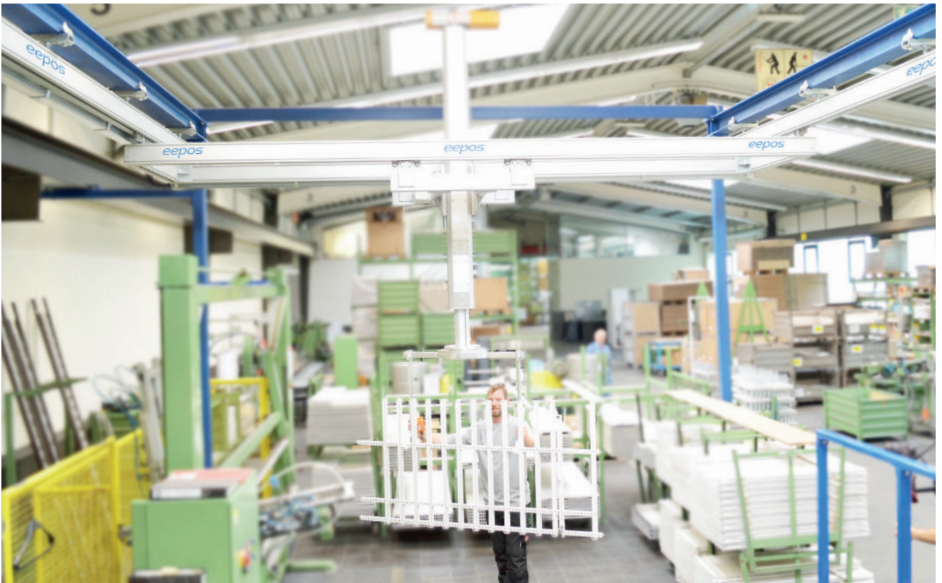
Bild oben: Starraufhängungen beim Einsatz der Hubachse Above: Rigid mounting when using the lifting axis
