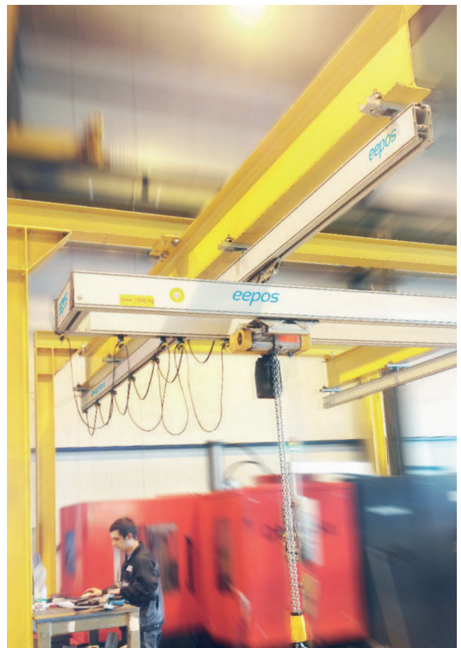
Bild oben: Starraufhängungen beim Einsatz der Hubachse Above: Rigid mounting when using the lifting axis
